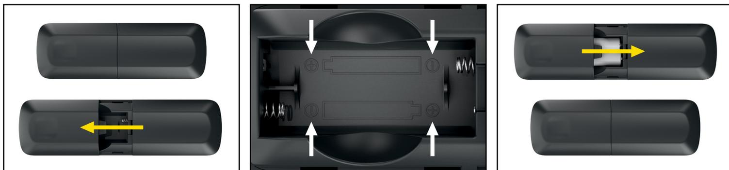
1. Para acceder a las pilas, presiona suavemente la tapa de la parte trasera del mando a distancia y, a continuación, desliza la tapa hacia fuera. Retira las pilas de su receptáculo y sigue las ordenanzas locales para desecharlas.
