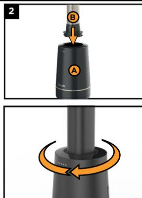
**2.** Utiliza las pegatinas de montaje para alinear la flecha roja impresa en el mástil con la flecha roja impresa en la base. Gira el mástil en el sentido de las agujas del reloj para bloquearlo en la base. Retira la cinta después de terminar el montaje.
